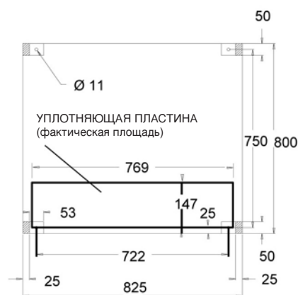
Рис. 2. Вид в плане 120 кВА
